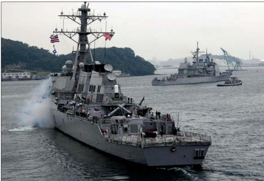
У првом плану разарач класе Arleigh Burke, у другом крстарица класе Ticonderoga – нишански радар AN/SPG-62 су иза димњака, оријентисани према назад
